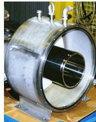
HESR-Prototyp Barrier Bucket (BB) Kavität
